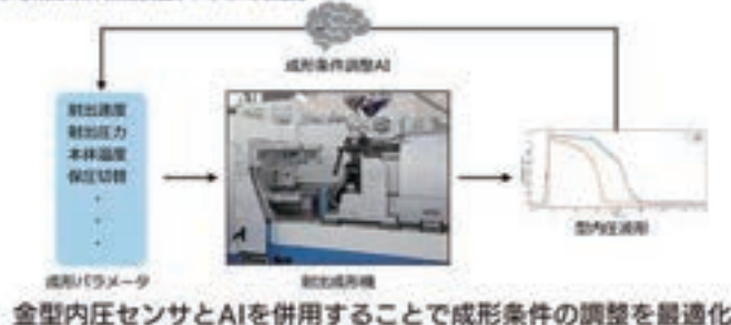
【AIによる成形条件自動調整システムの概要】
